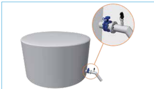
Выход из резервуара, после обратного клапана
